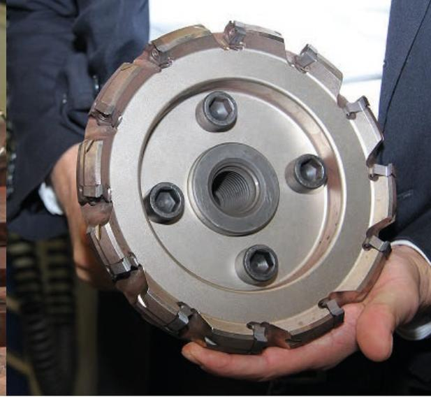
**Problem gelöst:** Mit dem Planfräser WSX445 von Mitsubishi Materials konnte eine große, instabile Schweißkonstruktion aus St52 hocheffizient und maschinenschonend bearbeitet werden.
